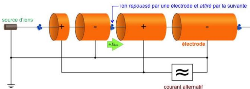
En plaçant différentes chambres d'accélération les unes à la suite des autres et en changeant alternativement les polarités des électrodes (armatures), les particules sont alors accélérées continuellement jusqu'à atteindre la vitesse désirée.
