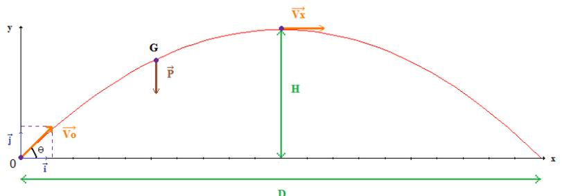
La **portée** est la distance horizontale maximale atteinte par le système (D sur le schéma).
