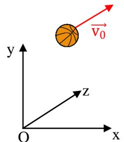
Ainsi, on obtiendra :  $\vec{a}_G \begin{cases} a_x(t) = 0 \\ a_y(t) = -g \\ a_z(t) = 0 \end{cases}$  puis  $\vec{v}_G \begin{cases} v_x(t) = v_{0x} \\ v_y(t) = -gt + v_{0y} \\ v_z(t) = 0 \end{cases}$
