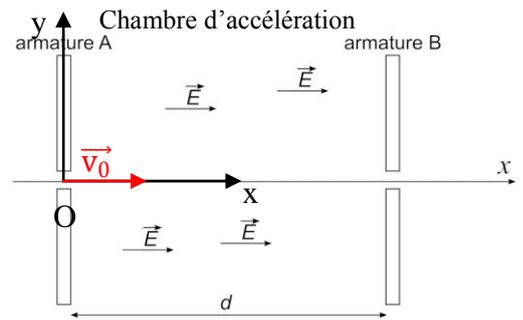
Dans l'exemple ci-dessus, l'armature A est chargée positivement, l'armature B négativement. Une particule chargée positivement arrivant dans la chambre avec la vitesse  $\vec{v}_0$  suivant l'axe des x va donc être accélérée suivant l'équation :
